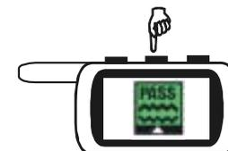
В сигнализации предусмотрена возможность дистанционного отключения / включения датчика удара по уровням неограниченное количество раз в течении одного цикла охраны.
