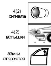
Если в режиме охраны появлялись сигналы тревоги в результате срабатывания зоны дверей, капота, багажника, включения зажигания или выключения ручного тормоза, и сигналы тревоги не прерывались с брелка, то при выключении режима охраны последуют 4 звуковых сигнала и 4 вспышки габаритов. На дисплее брелка отобразятся иконки, соответствующие причинам срабатывания сигнализации.
