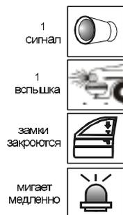
Перед включением режима охраны убедитесь, что зажигание выключено, двери, капот, багажник надежно закрыты, стояночный тормоз включен. Для включения режима охраны нажмите кнопку 1 брелка (кнопка 1 должна быть запрограммирована для включения/выключения режима охраны).
