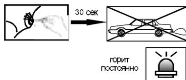
Если режим иммобилизатора запрограммирован, то двигатель будет автоматически блокироваться через 30 секунд после каждого выключения зажигания независимо от того, включался режим охраны или нет. После включения блокировки светодиодный индикатор горит постоянно.
