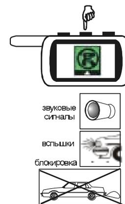
Для включения режима антиграбления переместите курсор на иконку
