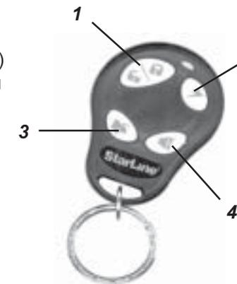
В брелке без обратной связи используется литиевый элемент питания CR2032, 3В. Время работы одного элемента питания зависит от частоты пользования брелком и от типа установленного элемента.
