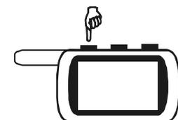
При включенном зажигании последовательное нажатие на кнопку 1 брелка будет приводить к поочередному закрыванию и открыванию замков дверей.
