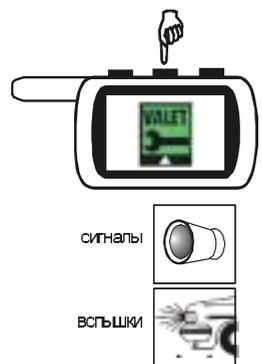
Для временного отключения противоугонных и охранных функций автосигнализации, например, при передаче автомобиля на станцию сервисного обслуживания для проведения профилактических или ремонтных работ рекомендуется включить служебный режим Valet.
