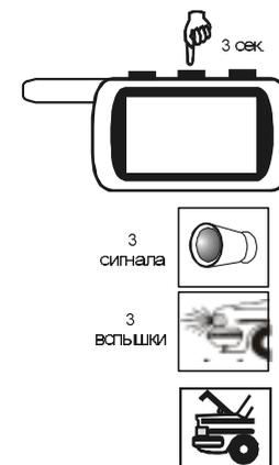
Канал №1 (желто-черный провод) может быть активизирован независимо от состояния системы и использован для дистанционного отпирания багажника. Если канал активизирован при включенном режиме охраны, то зоны багажника и датчика удара временно отключаются.
