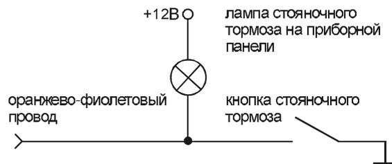
На автомобилях с автоматической КПП подключите этот провод к кнопке педали тормоза, замыкающейся на +12V при нажатии педали тормоза.
