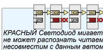
КРАСНЫЙ Светодиод мигает дважды(x2) каждую секунду: модуль не может распознать читаемый код. Этот модуль может быть несовместим с данным автомобилем.
