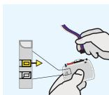
Если светодиод не горит КРАСНЫМ, **отключите** 4-контактный разъём (Data-Link) и вернитесь к пункту 1.
