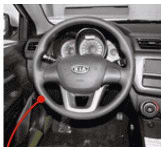
Салонный блок предохранителей
