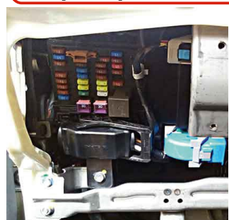
2 Салонный блок предохранителей
