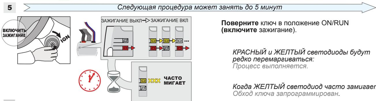
**Поверните** ключ в положение ON/RUN (включите зажигание).
