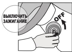
**Поверните** ключ в положение OFF (выключите зажигание).
