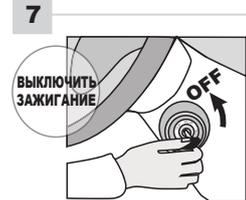
**Поверните** ключ в положение OFF (выключите зажигание).
