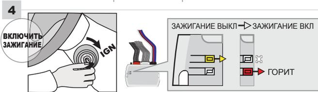
**Поверните** ключ в положение ON/RUN (включите зажигание).
