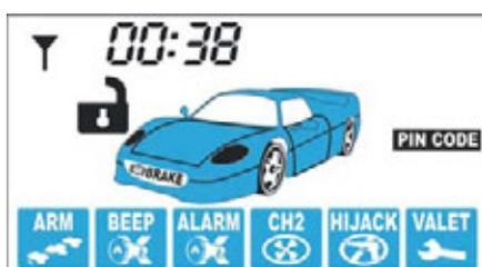
2. Войдите в режим установки PIN-кода. При выключенном зажигании нажмите сервисную кнопку VALET 4 раза. Каждое нажатие сопровождается загоранием светодиодного индикатора.
