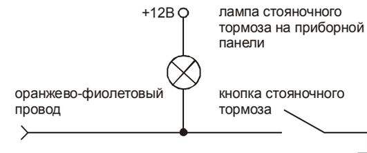
На автомобилях с автоматической КПП подключите этот провод к кнопке педали тормоза, замыкающейся на +12В при нажатии педали тормоза.
