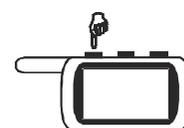
Нажмите кнопку 1 брелка. Система отреагирует 1 вспышкой габаритов. Прозвучат сначала 2 коротких, затем 2 длительных звуковых сигнала брелка. После приглушенного звукового сигнала брелка на его дисплее высветится постоянно иконка **AUTO ARM**, показывая активизацию автоматического включения режима охраны.
