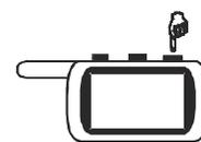
Нажмите и удерживайте кнопку 3 брелка в нажатом состоянии до появления сначала длительного, затем короткого звуковых сигналов брелка. После отпускания кнопки на индикаторе брелка начнет вспыхивать одна из иконок нижнего ряда. Короткими нажатиями кнопки 3 брелка установите курсор на иконку **MUTE ARM**.
