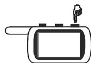
Для включения сервисного режима нажмите и удерживайте кнопку 3 брелка в нажатом состоянии до появления сначала длительного, затем короткого звуковых сигналов брелка. После отпускания кнопки на индикаторе брелка начнет вспыхивать одна из иконок нижнего ряда. Короткими нажатиями кнопки 3 брелка установите курсор на иконку **VALET**.
