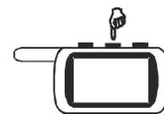
Выключить блокировку двигателя до следующего выключения зажигания можно одинарным нажатием кнопки 2 брелка или одинарным нажатием сервисной кнопки VALET при выключенном зажигании.
