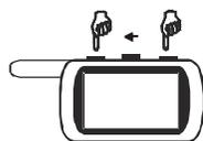
Включение / выключение канала №1 (желто-черный провод) осуществляется последовательным нажатием кнопок 3 и 1 брелка. Нажатие кнопки 3 должно быть длительным, нажатие кнопки 1 - коротким.
