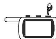
Нажмите и удерживайте кнопку 3 брелка в нажатом состоянии до появления сначала длительного, затем короткого звуковых сигналов брелка. После отпускания кнопки на индикаторе брелка начнет вспыхивать одна из иконок нижнего ряда. Короткими нажатиями кнопки 3 брелка установите курсор на иконку **AUTO IMMO**.
