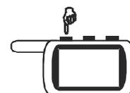
Нажмите кнопку 1 брелка. Система отреагирует 1 вспышкой габаритов. Прозвучат сначала 2 коротких, затем 2 длительных звуковых сигнала брелка, затем приглушенный звуковой сигнал брелка. На дисплее брелка постоянно высветится иконка **TURBO ON**, показывая активизацию автоматического включения режима охраны.
