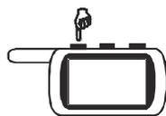
Для включения режима охраны дважды нажмите кнопку 1 брелка. Первое нажатие должно быть длительным, второе нажатие - коротким. 1 вспышка габаритов подтвердит включение режима охраны. Автоматическое запираение замков дверей произойдет, если они подключены к сигнализации. Светодиодный индикатор начнет мигать, показывая, что автомобиль охраняется.
