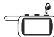
Для включения режима турботаймера нажмите и удерживайте кнопку 3 брелка в нажатом состоянии до появления сначала длительного, затем короткого звуковых сигналов брелка. После отпускания кнопки на индикаторе брелка начнет вспыхивать одна из иконок нижнего ряда. Короткими нажатиями кнопки 3 брелка установите курсор на иконку **TURBO ON**.
