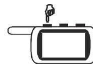
Нажмите кнопку 1 брелка. Система отреагирует 1 вспышкой габаритов. Прозвучат сначала 2 коротких, затем 2 длительных звуковых сигнала брелка, затем приглушенный звуковой сигнал брелка. На дисплее брелка высветится постоянно иконка **MUTE ARM**, показывая активизацию автоматического включения режима охраны. При выключении режима бесшумной охраны иконка **MUTE ARM** погаснет.
