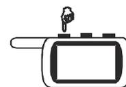
Нажмите кнопку 1 брелка. Система отреагирует 1 вспышкой габаритов. Прозвучат сначала 2 коротких, затем 2 длительных звуковых сигнала брелка, затем приглушенный звуковой сигнал брелка. На дисплее брелка высветится постоянно иконка **AUTO IMMO**, показывая активизацию автоматического включения режима охраны. При выключении режима иммобилизатора иконка **AUTO IMMO** погаснет.
