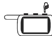
Нажмите и удерживайте кнопку 3 брелка в нажатом состоянии до появления сначала длительного, затем короткого звуковых сигналов брелка. После отпускания кнопки на индикаторе брелка начнет вспыхивать одна из иконок нижнего ряда. Короткими нажатиями кнопки 3 брелка установите курсор на иконку **AUTO ARM**.
