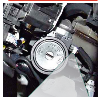
Разъем иммобилайзера на замке зажигания
