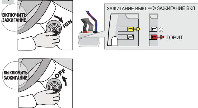
**Поверните** ключ в положение ON/RUN (включите зажигание).
