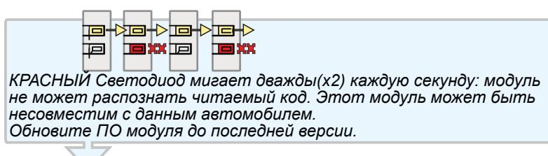
КРАСНЫЙ Светодиод мигает дважды(x2) каждую секунду: модуль не может распознать читаемый код. Этот модуль может быть несовместим с данным автомобилем.
